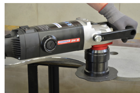
Chanfreinage des bords courbés
