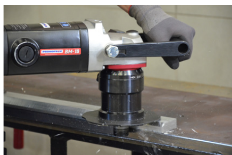
Chanfreinage de l'aluminium
