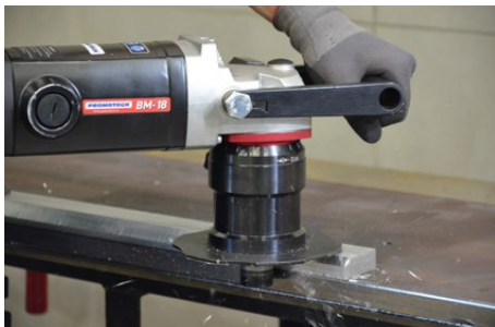
Chanfreinage de l'aluminium
