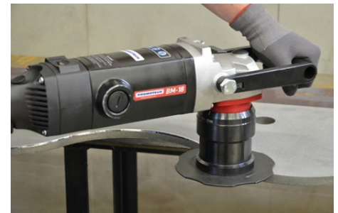
Chanfreinage des bords courbés
